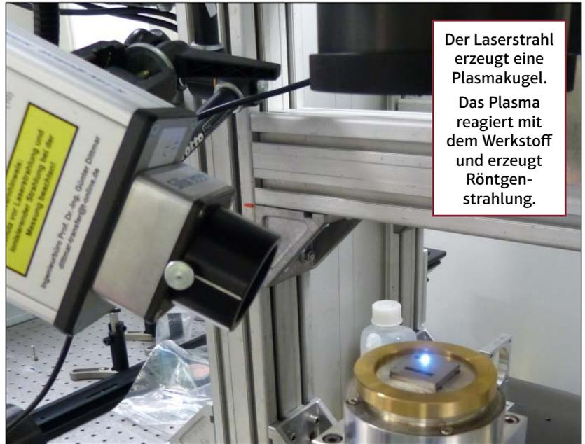
*Abb. 1: Der Sensor SILIX lambda überwacht den Laserprozess. Die Röntgenstrahlung entsteht zwangsweise und kann zur Prozesssteuerung und zur Materialanalyse genutzt werden. Zu hohe Röntgenstrahlung führt zum Abschalten des Lasers und garantiert den Schutz des Menschen.* © G. Dittmar
